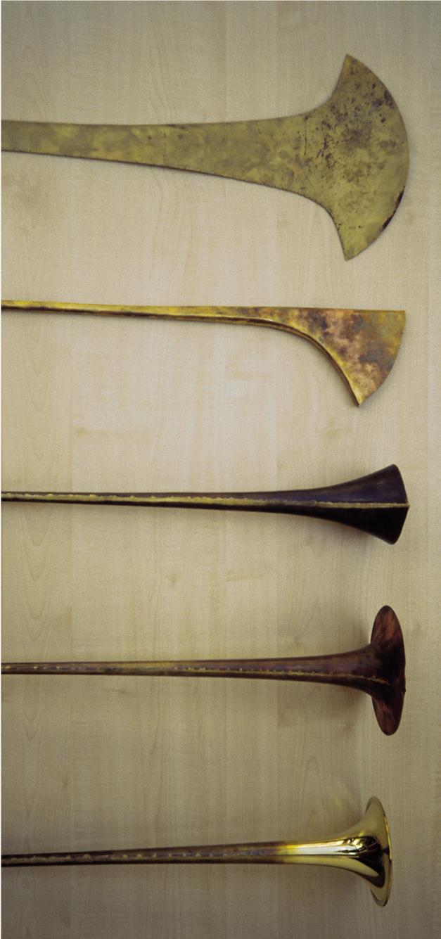
Die Schallstücke werden aus Blech ausgeschnitten und verzahnt.
